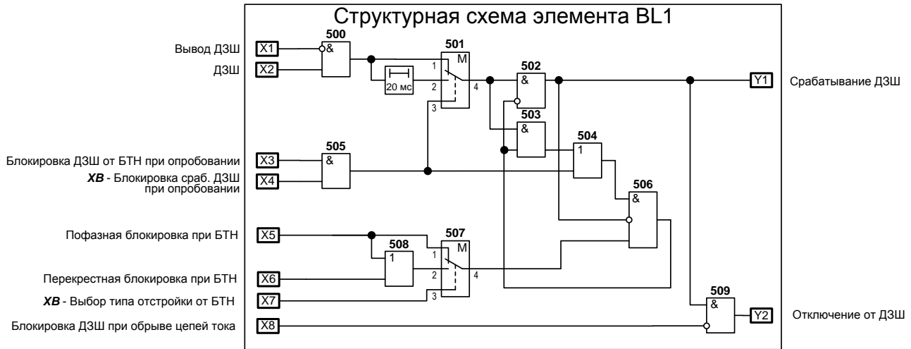
Рисунок 2 – Функциональная логическая схема блока BL1 логики ДЗШ
